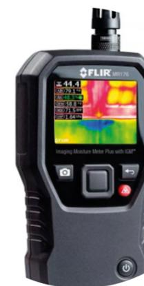
Medidores de umidade são capazes de quantificar a água no estado de vapor em determinados locais e ajudam a identificar infiltrações e umidade nas obras sem quebrar paredes.
