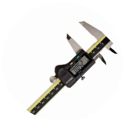
O paquímetro é utilizado para medir distâncias internas e externas com extrema precisão. O instrumento deve ser ajustado entre dois pontos; após ser retirado do local, a medição pode ser lida em sua régua. A escala de medição (nônio ou vernier) contida no cursor móvel permite uma exatidão decimal de leitura.
