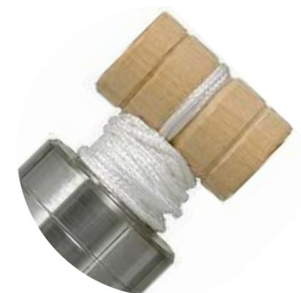
O prumo é um instrumento utilizado para conferir a verticalidade de paredes e colunas, bem como para elevar o ponto. Trata-se de um pequeno peso de metal, com uma das extremidades presa a um fio fixado a uma base (de madeira ou outro material) para referência. Ele pode ser adaptado a um prisma ortogonal ou a um tripé.
